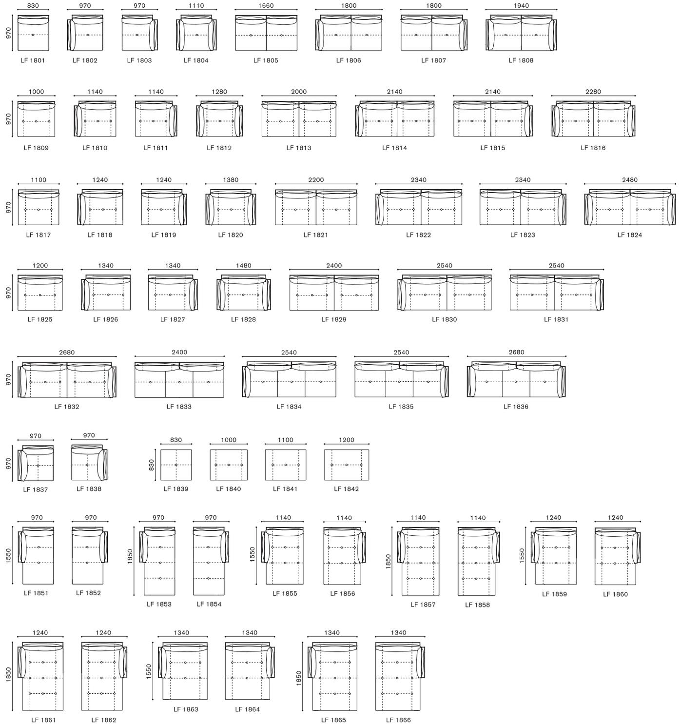
※点線-----は皮革張り仕様時(AL・L・LE・LXクラス)の縫製ライン、丸印○は皮革張り仕様時(AL・L・LE・LXクラス)の縫合せ絞りの位置です。
